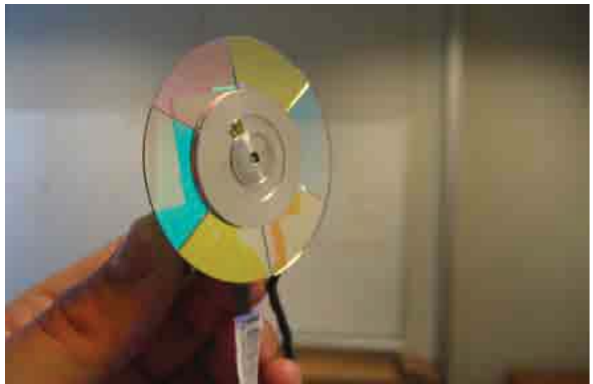
Het kleurenwiel dat in een DLP-projector zit, kleurt de beelden in die uiteindelijk op het scherm verschijnen.
